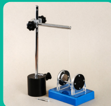
دستگاه بررسی خواص مغناطیسی مواد
